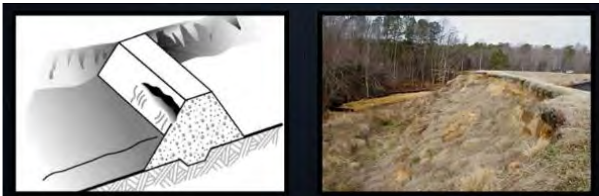
Figura 1.7 Falla por deslizamiento de talud. U.S. Department of Agriculture (2012).
