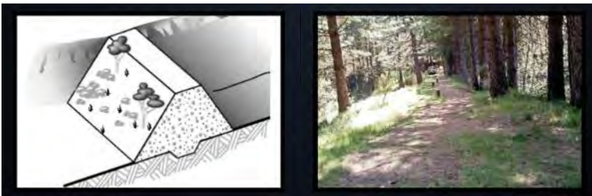
Figura 1.10 Falla por vegetación excesiva en la cortina. U.S. Department of Agriculture (2012).
