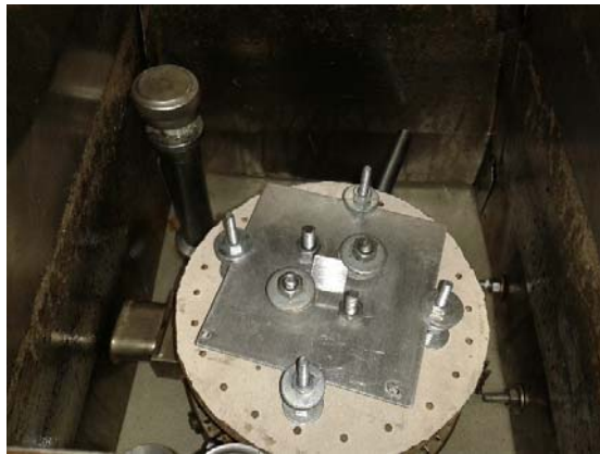
Figura 2.4.1. Probeta sujeta a la base giratoria del spin-coating.
