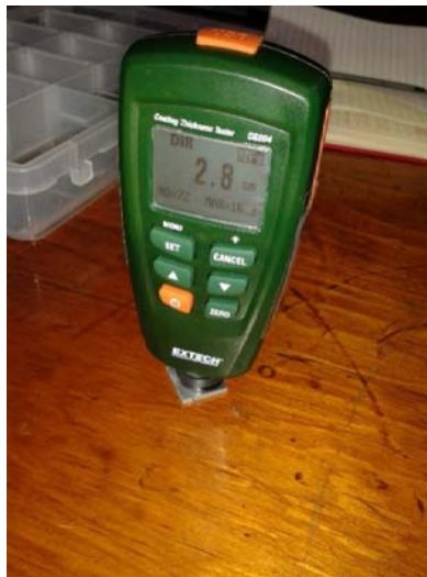
Figura 2.5.2. Foto de la medición de espesores de una probeta con sol-gel.
