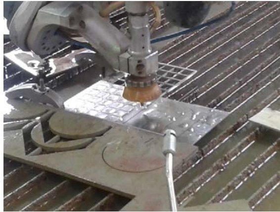
Figura 2.2.1. Probetas de aluminio cortadas por chorro de agua.
