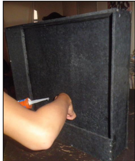
Figura 8. Aplicación de sellador y silicón.
