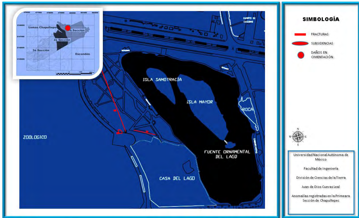
Figura 35. Fracturas relevantes localizadas alrededor del lago de Chapultepec, Primera Sección del Bosque de Chapultepec.
