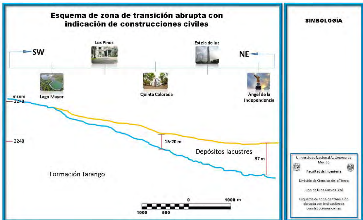
Figura 28. Esquema de zona de transición abrupta con indicación de construcciones civiles.
