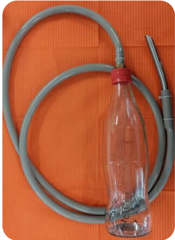
Fig. 34 Bomba de vacío
