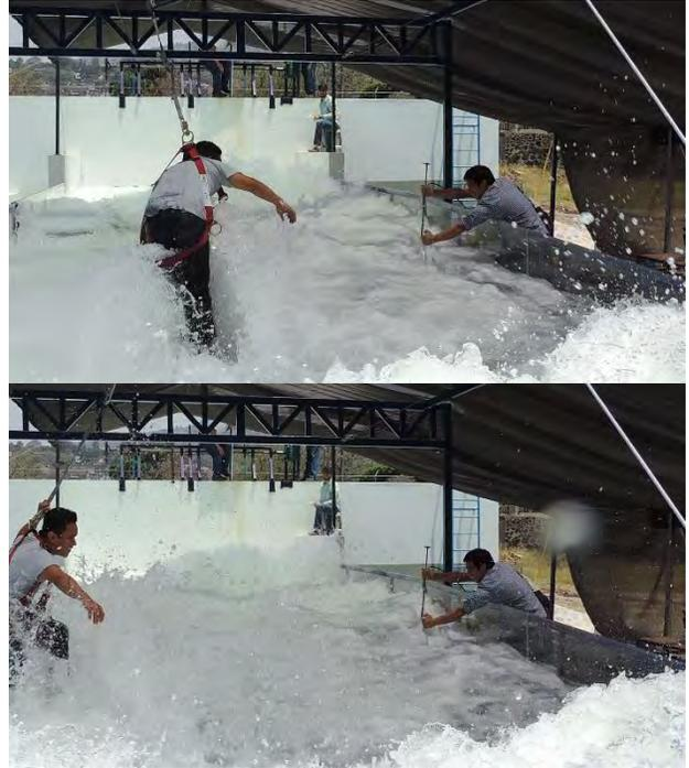
Figura 5-2 Prueba de estabilidad al vuelco (2)
