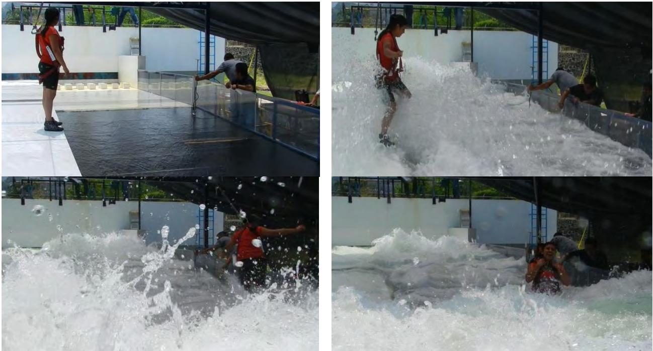
Figura 5-5 Prueba de estabilidad al vuelco (5)
