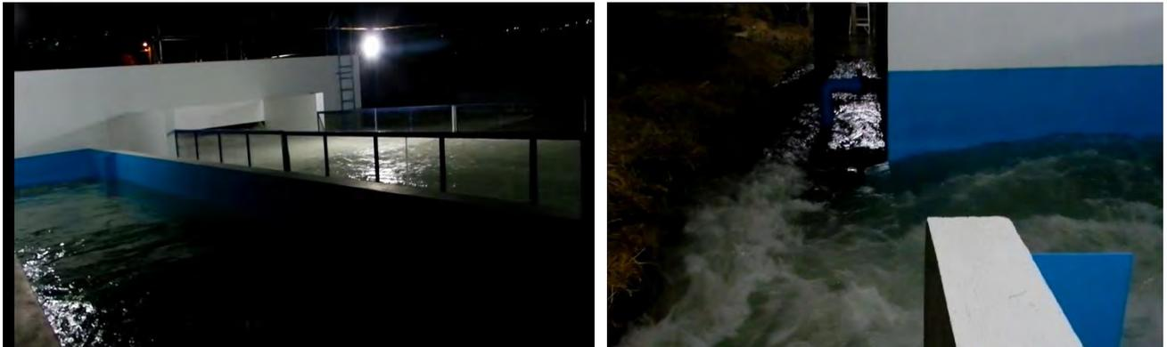
**Figura 4-89 Velocidades altas y desbordamiento a la salida del módulo**
