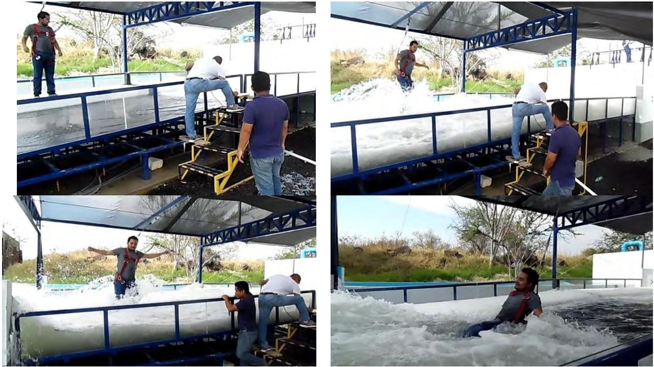
Figura 5-4 Prueba de estabilidad al vuelco (4)
