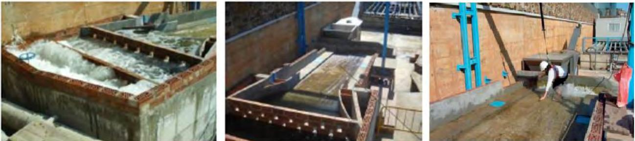
Figura 2-12 Módulo físico de calle, ejemplo de pérdida de estabilidad
