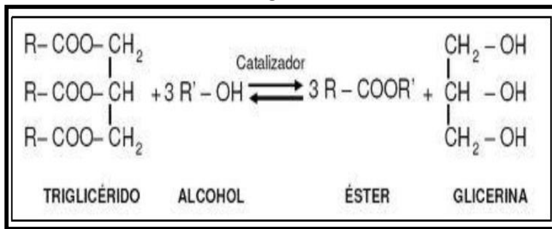
Figura 4.1 Esquema general de la reacción de transesterificación de aceites vegetales
