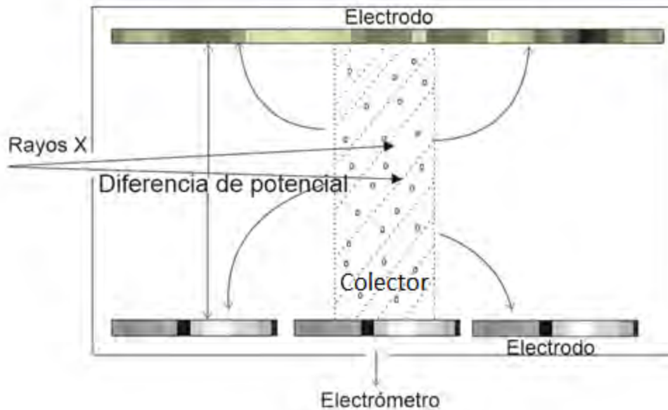
Figura 29: Esquema de una cámara de ionización, adaptado de [18]
