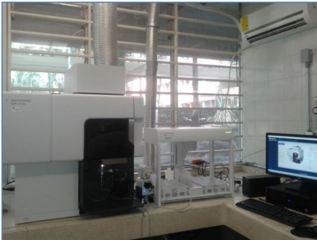
Figura 17. Espectrómetro de emisión óptico por plasma acoplado inductivamente (ICP-OES) en el LABQA.
