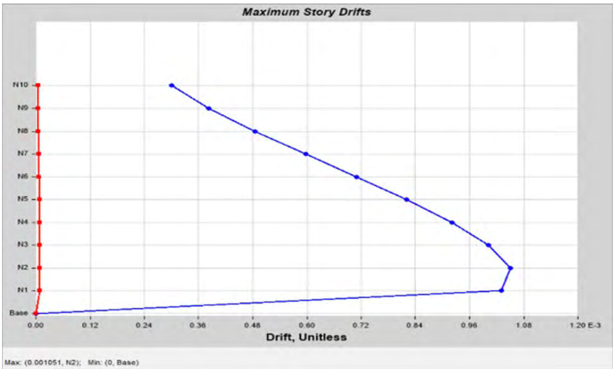
Figura 3.11 Distorsiones, edificio aislado
