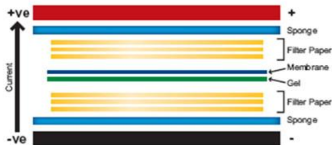
Figura 3. Representación esquemática de los componentes requeridos para la inmunoelectrotransferencia de proteínas de un gel de poliacrilamida SDS a una membrana de nitrocelulosa
