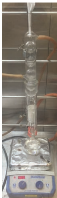
Figura A1.5: Sistema montado de extracción Soxhlet de 500ml.
