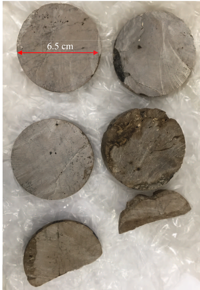
Figura 6. Núcleo de yacimiento (M175-I) cortado en diversas placas (antes de pulir)
