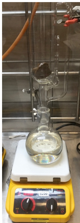
Figura A1.6: Extractor de 1L y matraz de bola con núcleo.
