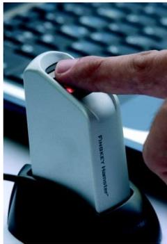
Figura 2.4 Lector de huella con enlace a computadora
