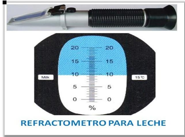
**Fig 2. Refractómetro para leche**
