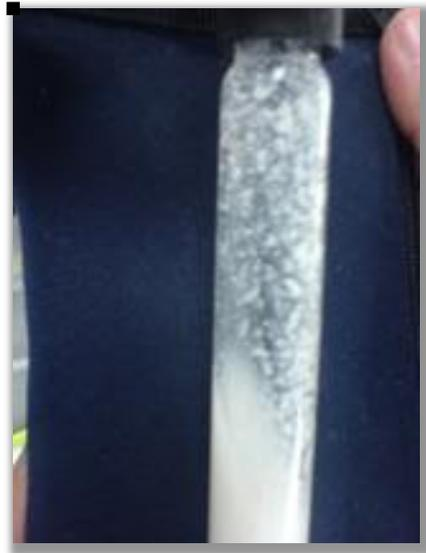
**Fig. 4 Floculación en prueba de alcohol al 68%**
