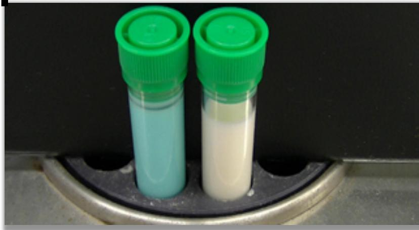
**Fig. 10 Cambio de color prueba de tiempo reducción azul de metileno**
