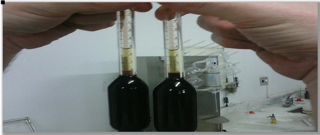
**Fig. 7 Butirómetro de Gerber**
