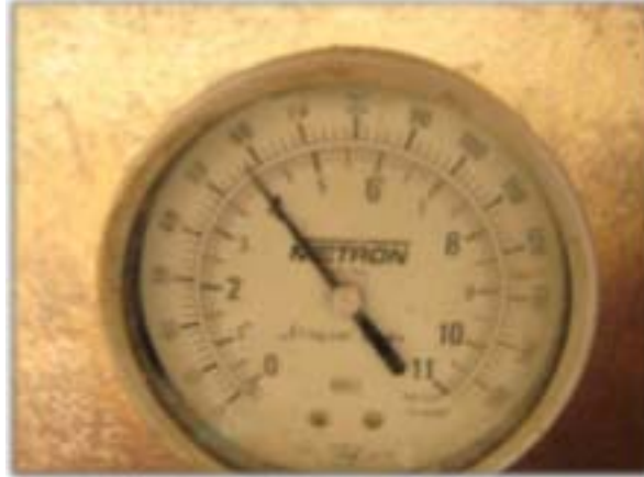
Figura 2.8. Manómetro con lectura de la presión de la red dentro del cruceo 91
