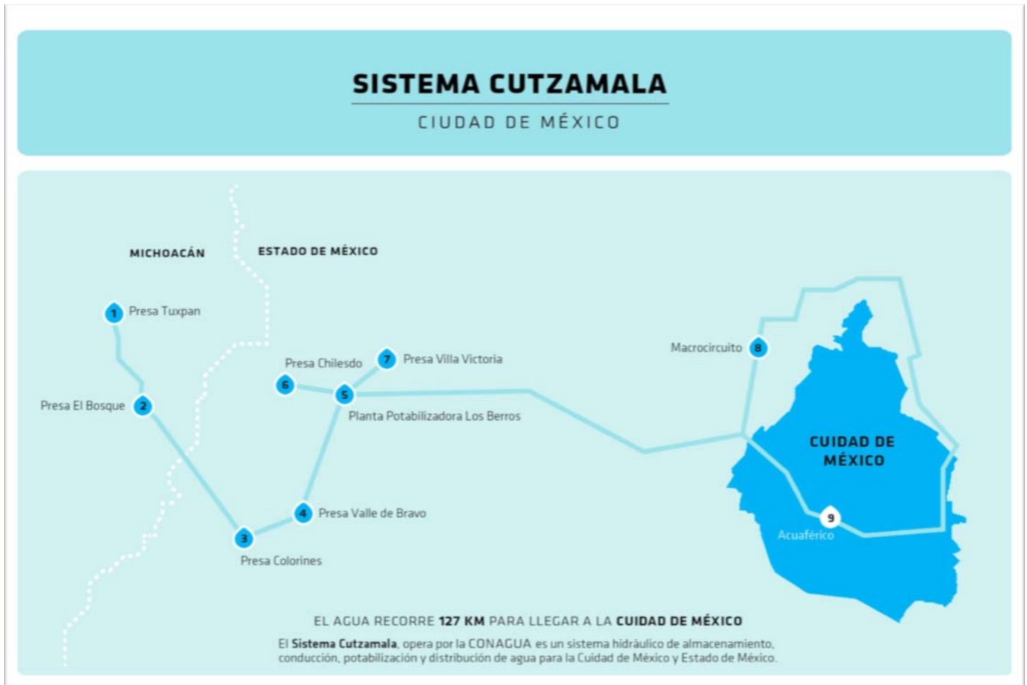
Figura 1.2. Sistema Cutzamala para el abastecimiento de agua potable en la Ciudad de México
