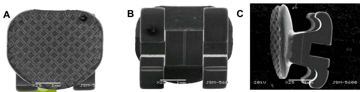
**Figura 26.** Observación en SEM a 25x de bracket Gemini de 3M, donde podemos observar A) malla sencilla del bracket, no se presentan defectos, B) bracket visto de frente donde podemos observar que no se presentan defectos, C) bracket en vista lateral donde podemos observar la soldadura de unión.
