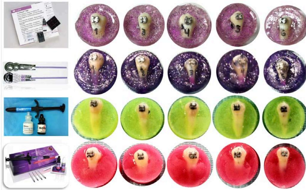
**Figura 34.** Imagen donde se observan las muestras incluidas en acrílico para el ensayo de resistencia al desprendimiento.
