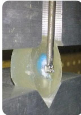
**Figura 23.** Esquema del ensayo de resistencia al desprendimiento donde pueden observar la cizalla durante el ensayo.
