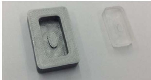
**Figura 3.11** Molde de PLA (izquierda) y réplica en PDMS de la cámara neumática (derecha).
