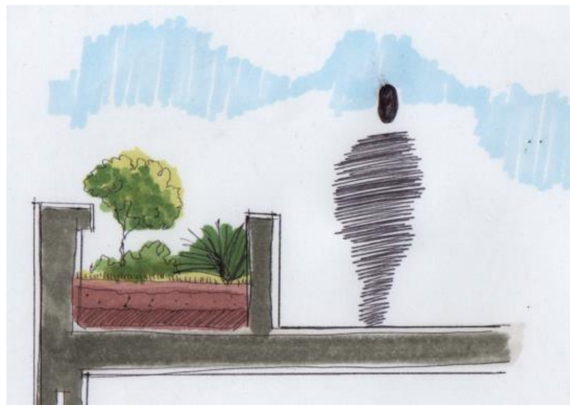
Sección vegetación en azotea. Imagen propia
