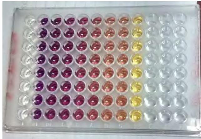
**Figura 13.** Placa de 96 pozos con la reacción de DPPH y el antioxidante de referencia.
