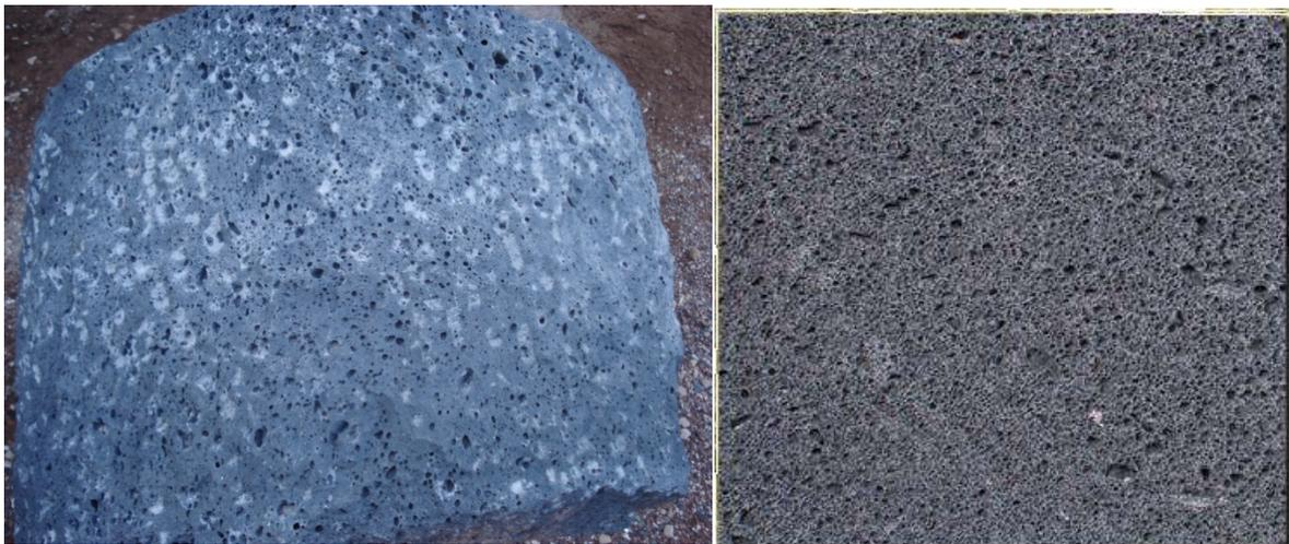
Figs. 14 y 15. En la imagen del lado izquierdo se nota la porosidad de la piedra de resinto, mientras que en la imagen de la derecha se observa una textura más compacta.
