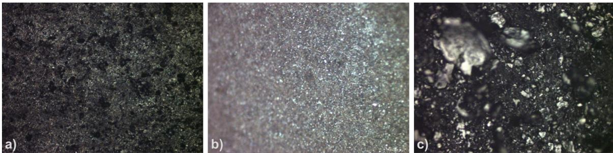
**Figura 2.6:** Fotografías con el microscopio de recubrimientos para PDMS a) nanotubos multipared b) fullerenos C60 c) nanotubos de una sola pared
