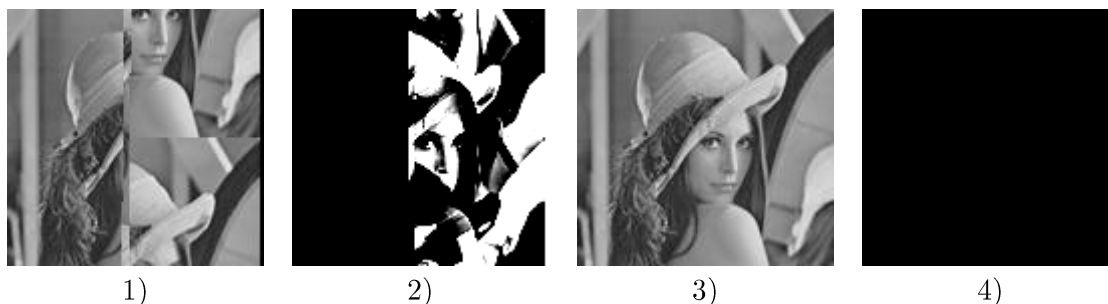
Figura 5.8: “Lena” resultante de 3 [m] de distancia. 1) Imagen recibida sin codificación. 2) Errores sin codificación. 3) Imagen recibida con codificación BCH con UEP. 4) Errores con codificación BCH con UEP.
