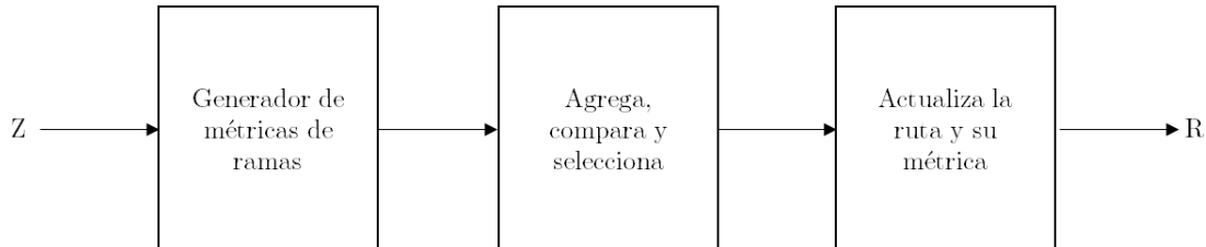
Figura 2.15: Representación del algoritmo de Viterbi.
