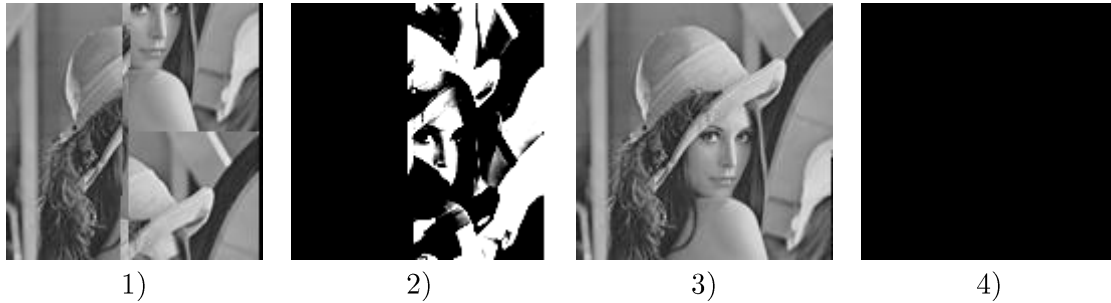
Figura 5.12: “Lena” resultante con 3 [m] de distancia. 1) Imagen recibida sin codificación. 2) Errores sin codificación. 3) Imagen recibida con codificación convolucional y RCPC, con UEP. 4) Errores residuales con codificación convolucional y RCPC, con UEP.
