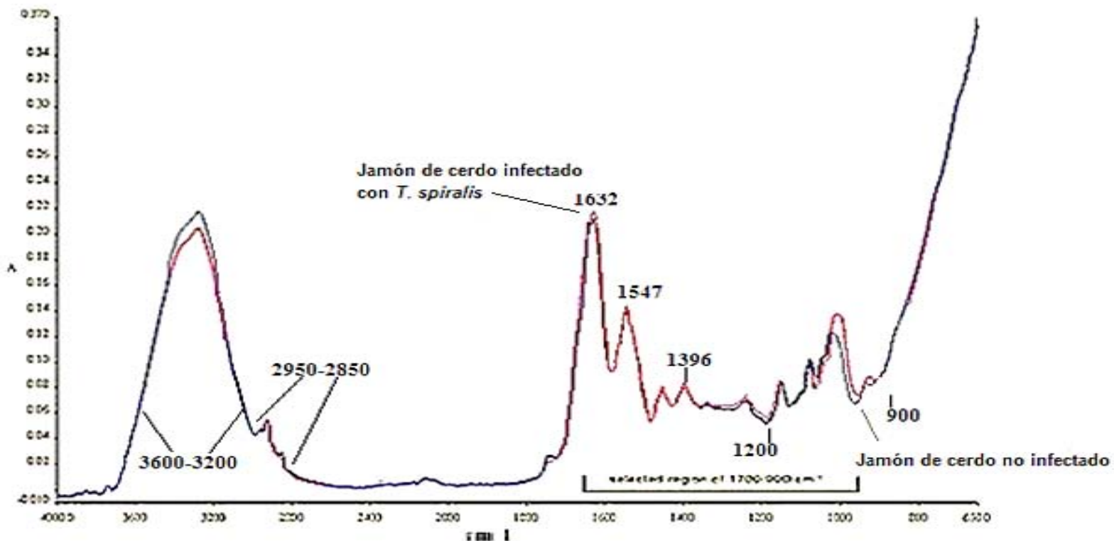
Figura 22. Espectros obtenidos por FTIR-HATR de jamón de cerdos infectados y no infectado con T. spiralis . Se muestra la absorbancia en función de la longitud de onda del jamón. La banda 3600-3200 \text{cm}^{-1} corresponde a la vibración de grupos OH de agua, los dos picos a 2950-2850 \text{cm}^{-1} pertenece a enlaces CH. La pequeña banda a 1740 \text{cm}^{-1} se puede atribuir a la presencia de grupos funcionales de triglicéridos. La región seleccionada 1700-900 \text{cm}^{-1} manifiesta la mayor variabilidad entre las bandas de absorción y corresponde a la “huella digital” del parásito lo que permite una discriminación entre jamón con larvas de Trichinella y el mismo producto pero sin presencia de ellas. En esa región se observan las bandas de proteínas amida I (1632 \text{cm}^{-1} , C=O) y de amida II (1547 \text{cm}^{-1} ). La pequeña banda en 1396 \text{cm}^{-1} se debe a COO - correspondiente a las vibraciones de estiramiento de los ácidos grasos y proteínas. En la región de 1200-900 \text{cm}^{-1} se atribuyen a los hidratos de carbono tales como el glucógeno. En color rojo se muestra jamón con LM del parásito y en azul jamón sin LM.
