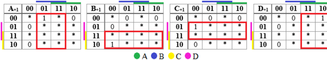
Figura 4.11 Mapas de Karnaugh para la 2ª dirección de un motor unipolar.
