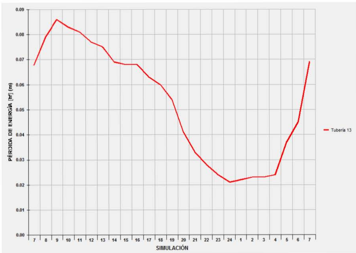
Gráfica 5.24 Pérdidas de carga por fricción en la tubería 13 a lo largo del día.
