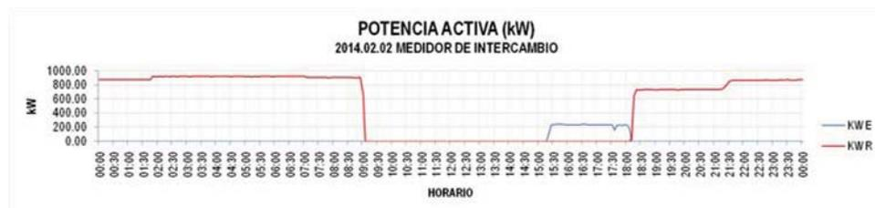
Figura 6.12: Perfil de mediciones de potencia activa del alimentador en KCR.
