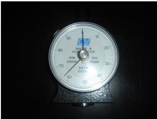
Figura 2. Durometro 306 L tipo A
