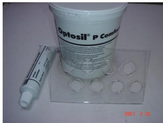
Figura 1 Material de impresión Optosil® Comfort y formaleta de acrílico.
