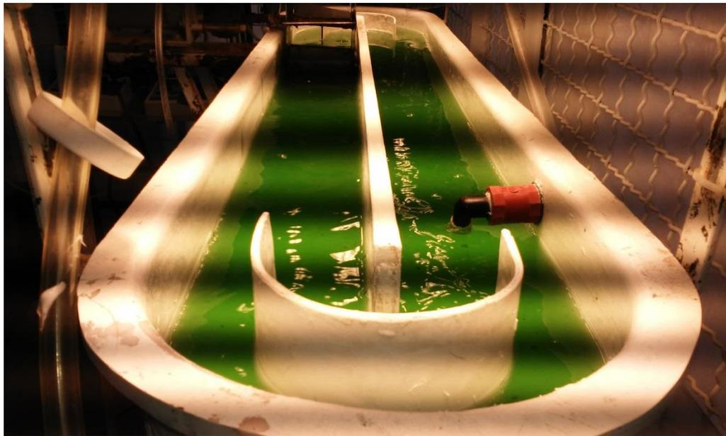
Figura 3.5.1. Reactor de lagunaje de alta carga (HRAP)
