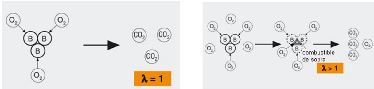
Imagen 4. Modelos de combustión con y sin exceso de aire. Fuente: (Testo Argentina SA, 2016)
