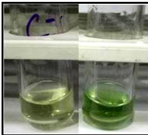
Figura 4.5. Prueba de Liebermann-Burchard. A la izquierda tubo control, a la derecha tubo del extracto Ala-DM, la coloración verde intensa indica la presencia de esteroides.
