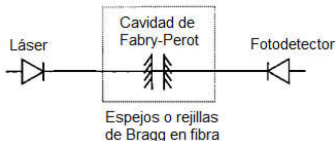
Figura 1.17 Hidrófono basado en la configuración del interferómetro de Fabry-Perot.
