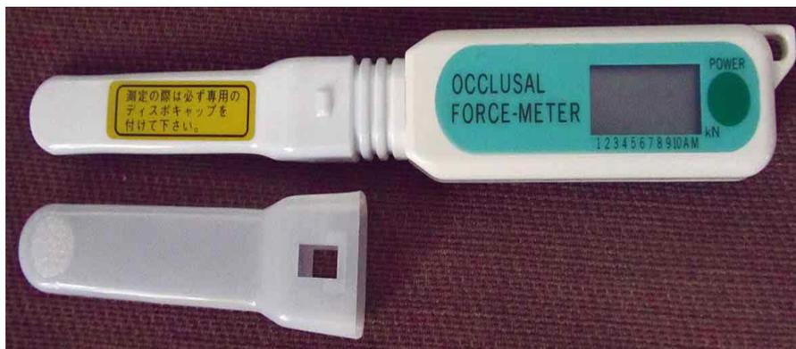
*Fig 3.* Medidor de fuerza basado en cambios de presión hidráulica.
