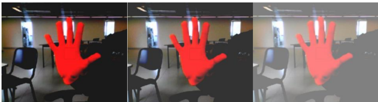
Figura 44. De izquierda a derecha se muestra el aumento de brillo en la imagen modelo.
