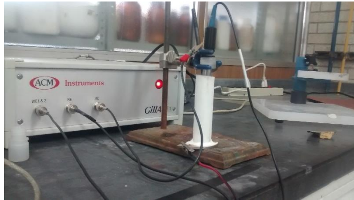
Figura 8: Celda electroquímica completa para prueba de EIE.
