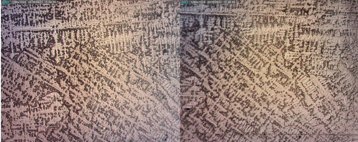
Figura 10: Bronce C62 atacado con cloruro férrico (izquierda) y con dicromato de potasio (derecha). 5x.
