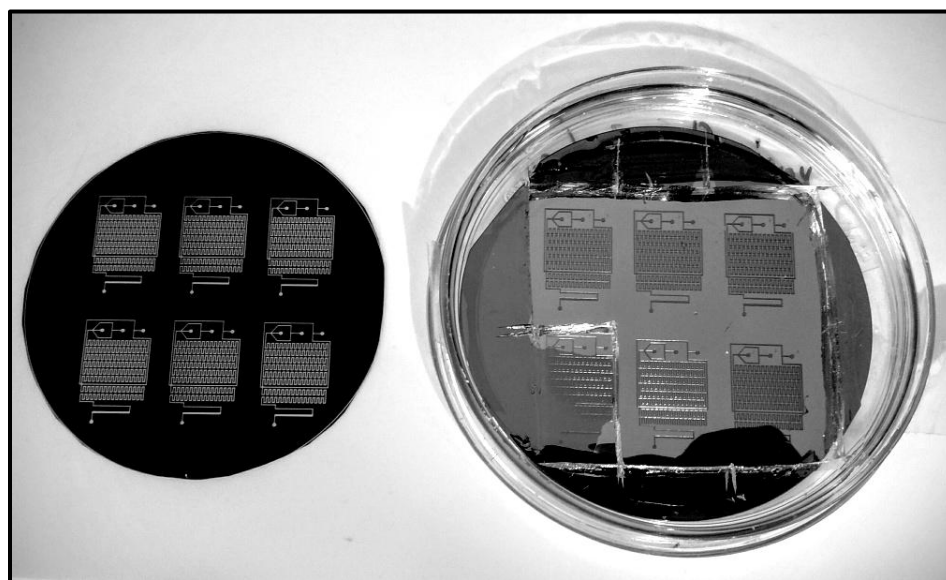
Figura 39. Máscara de acetato (izquierda) y molde con PDMS construido (derecha).
