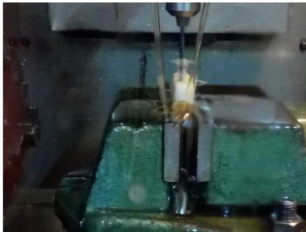
Fig. 4.3.3 Barrenado de la pieza "Caja tensor 1A" con una broca de 5/32 in.
