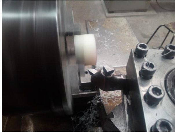
Fig. 4.3.2 Cilindrado de pieza con un diámetro excedido.
