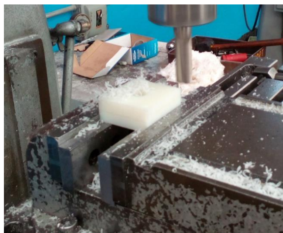
Fig. 4.3.5 Disminución de espesor en la pieza "Placa".
