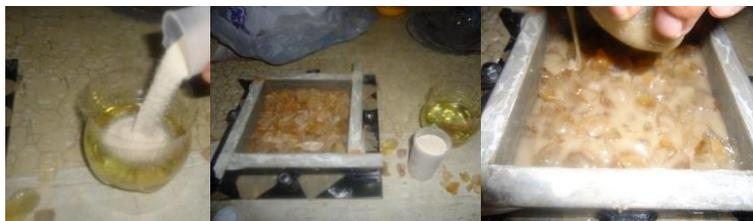
Ilustración 102 Capturada con fines académicos "Prueba III FABRICACION CONCRETO TRANSLUCIDO" 16-03-14, Fotografía Maribel Jaimes Torres
