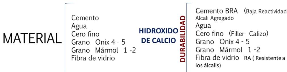
AGREGADO DE MARMOL .3-5 mm (1-2) / AGREGADO DE ONIX 15-20 mm (4-5)
