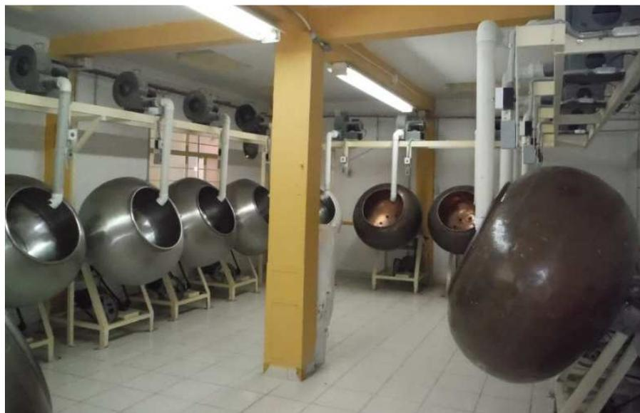
Ilustración 28 – Bombos con ventilación forzada.
