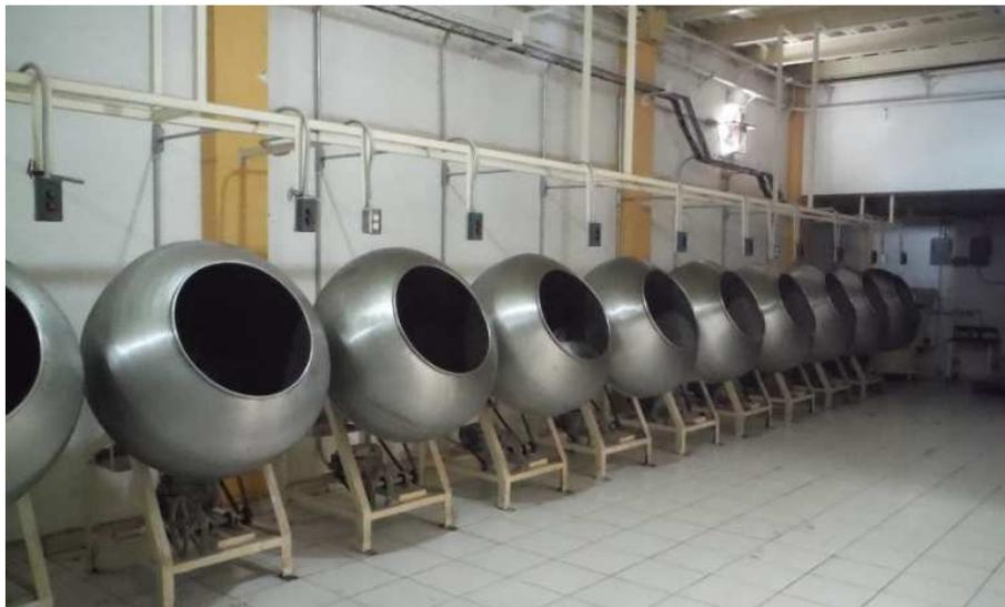
Ilustración 26 – Bombos con motor eléctrico de 1 HP
