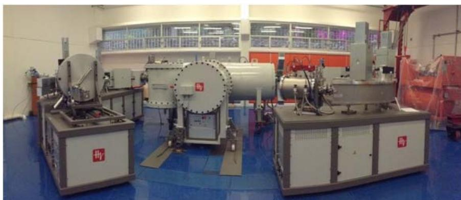
Figura 3.1: Espectrómetro de masas con aceleradores empleado en el LEMA.
