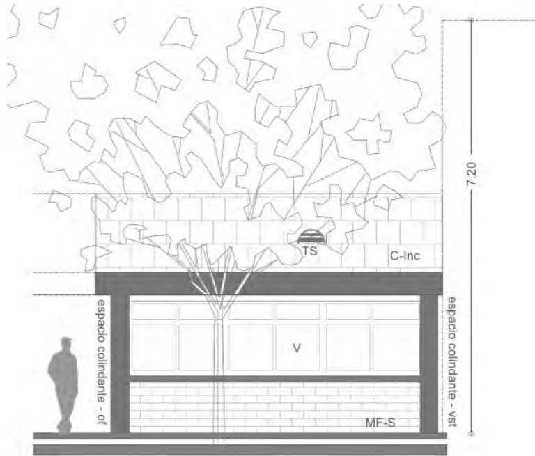
Figura 4.3: Fachada (F-01) de la oficina de la dirección del IER-UNAM, donde TS es el tubo solar en la cubierta, V es ventana, MF-S es muro fachada sur, y C-Inc es cubierta inclinada. Las cotas están en metros.
