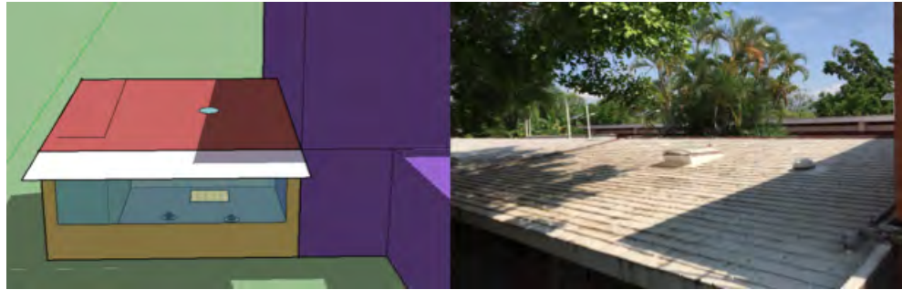
Figura 3.11: Comparación a las 11:00 horas del día 27 de mayo del 2015, del sombreado entre el modelo simulado y el registro fotográfico de la azotea de la oficina de dirección en el IER-UNAM.
