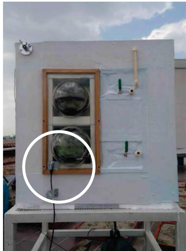
*Ilustración 82. Colocación de termistor en vidrio exterior. Imagen propia*
