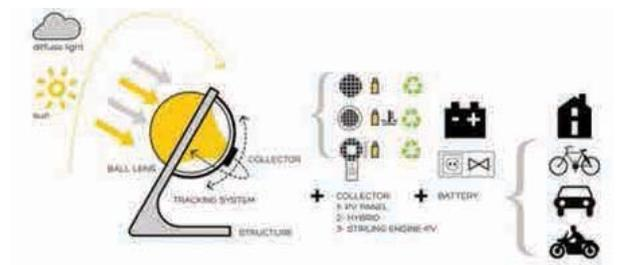
*Ilustración 15. Esquema de funcionamiento del concentrador de esfera. Ilustración obtenida para fines didácticos de: <http://conciencia-sustentable.abilia.mx/generador-esferico-supera-la-eficiencia-de-los-paneles-solare>*
