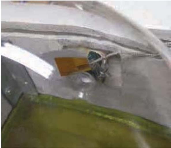
*Ilustración 76. Colocación de cable termopar en esfera superior.
