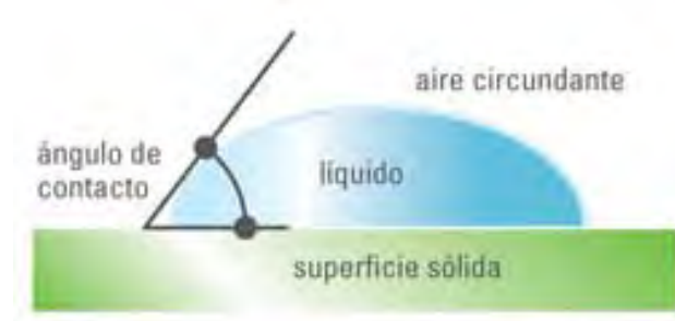
Figura 5 Representación del ángulo de contacto sobre una superficie.
