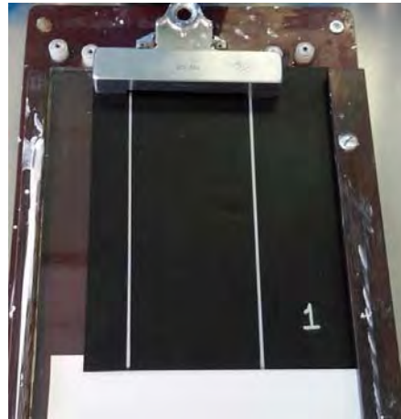
Figura 16.2 Sujetador de leneta para aplicación
