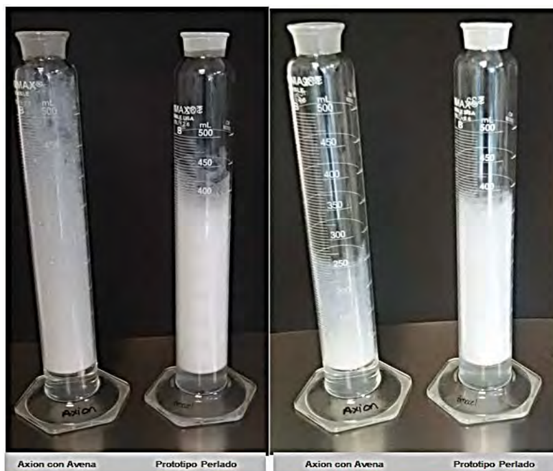
Figura 13.3. Resultados de prueba de espuma. Tiempo 0 y Tiempo 15.
