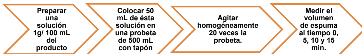
Figura 12.5. Procedimiento de evaluación de espuma.
