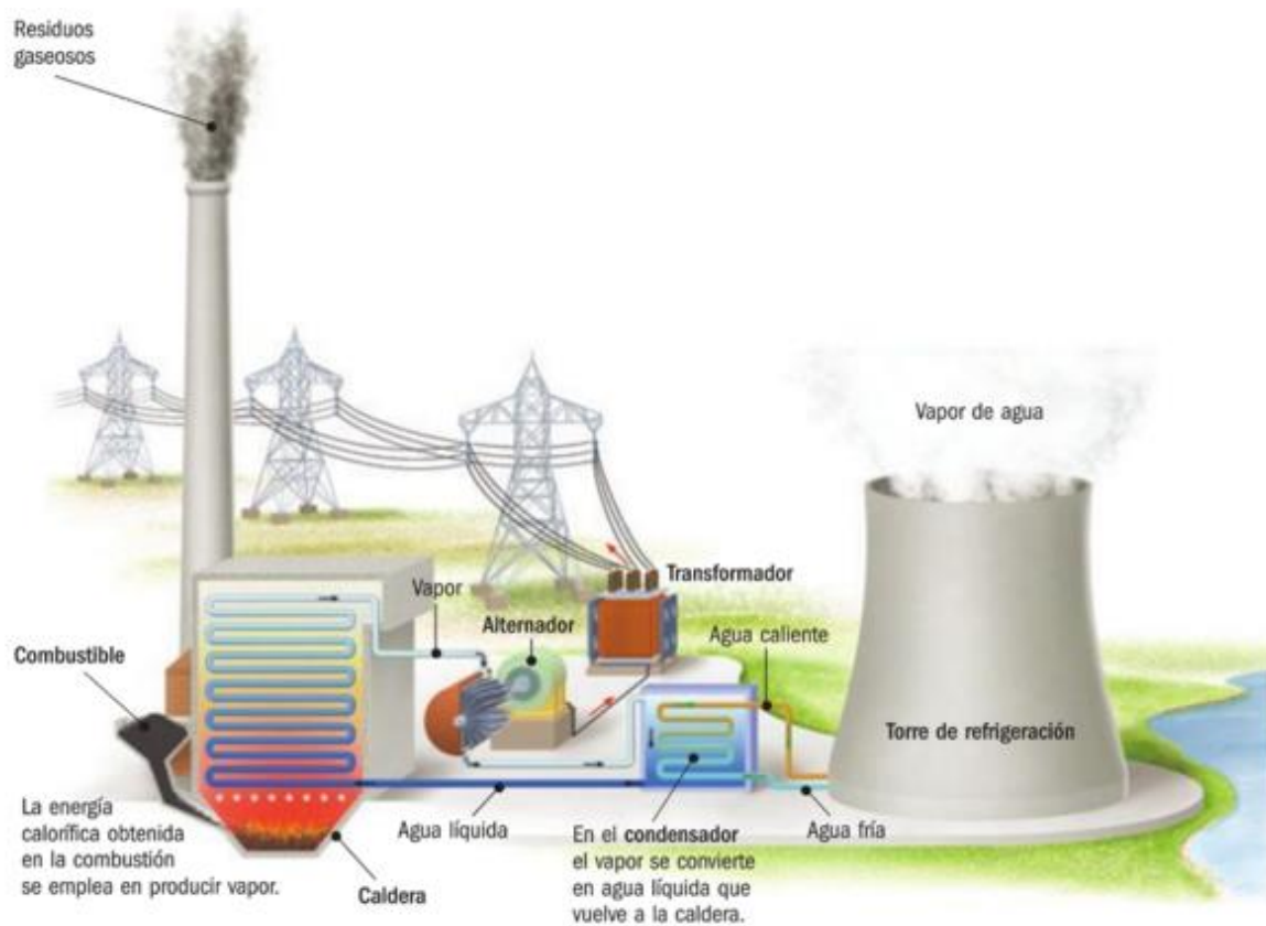
Ilustración 6. Esquema de una central termoeléctrica convencional.
