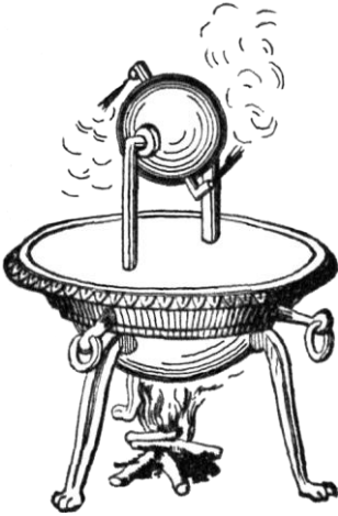
Ilustración 1. Eolípila de Herón. Fuente. https://es.wikipedia.org/wiki/Eolípila , 2016.
