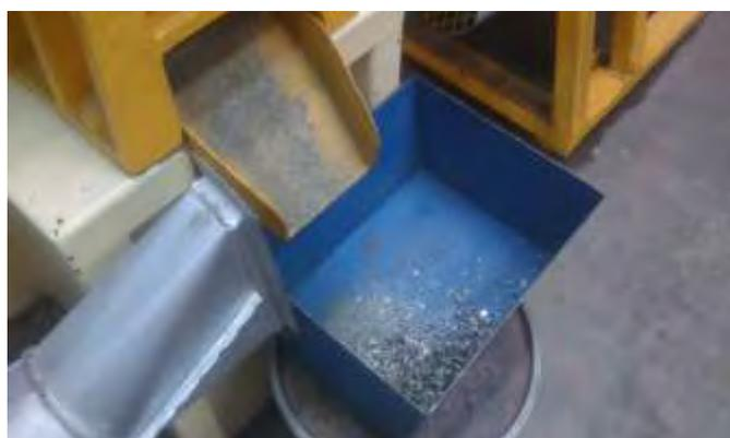
Fotografía 3. Quebradora de quijada que permite reducir la muestra a tamaños de  $-5$  pulgadas, con el fin de realizar de una manera más sencilla la preparación mecánica.
