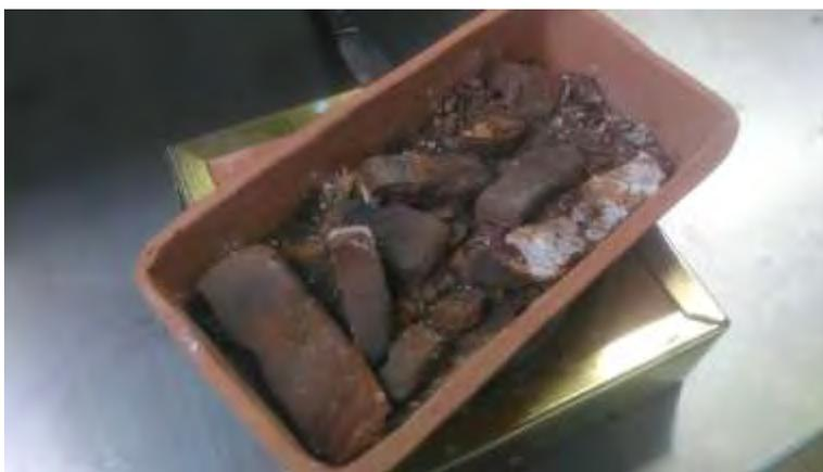
Fotografía 8. Oxidación del Mineral de cabeza (aglomerado), transcurridas las 4 h.
