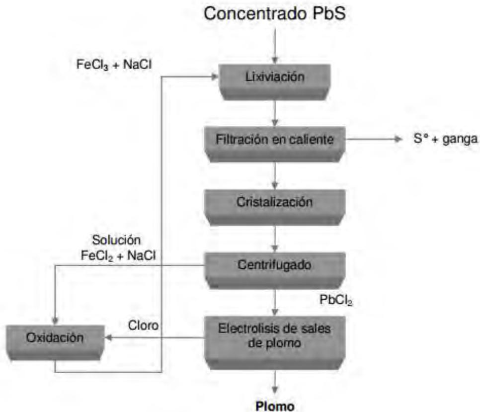
Diagrama 3. Proceso para producir Pb por lixiviación de PbS con FeCl<sub>3</sub> [27].
