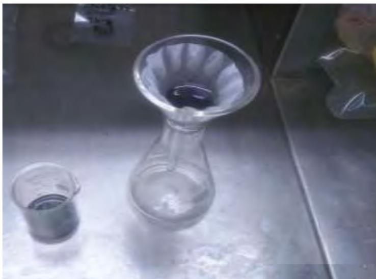
Fotografía 15. Filtración de la solución rica con contenidos de Pb y Zn.
