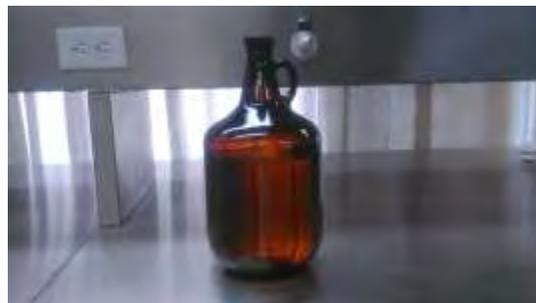
Fotografía 10 (Izquierda): Muestra la solución rica de Pb y Zn con NaOH, filtrada en 4 matraces de 1 litro de capacidad, debido a que no se cuenta con matraces de mayor capacidad. Fotografía 11 (derecha): Muestra la solución rica de Pb y Zn con NaOH, almacenada ya en un sólo recipiente.
