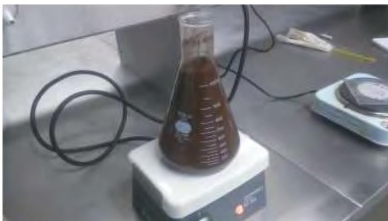
Fotografía 9. Lixiviación del mineral de cabeza de Pb y Zn con NaOH a temperatura ambiente, presión atmosférica y agitación magnética en un matraz Erlenmeyer de 1L de volumen.
