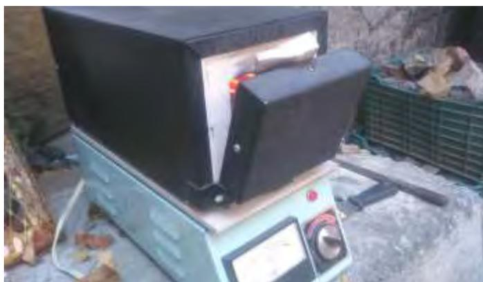
Fotografía 6. Pequeña mufla en donde se realiza la tostación del mineral de Pb y Zn con el objetivo de convertir los sulfuros en óxidos.
