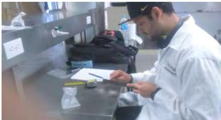
Fotografía 13. Variación de la longitud de los trozos cilíndricos de Al, con ayuda de una lima metálica.
