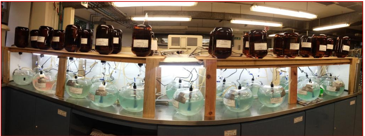
Figura 17. Montaje completo Sistema experimental – ecotoxicidad con modelo ( Danio rerio ) expuestos a contaminantes
