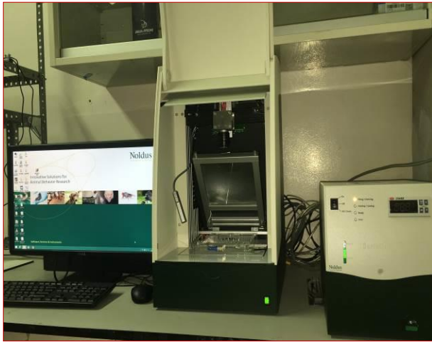
Figura 34. Equipo Danio Vision para pruebas de comportamiento
