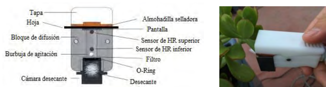
Fig. 13. Estructura del porómetro de Decagon.
