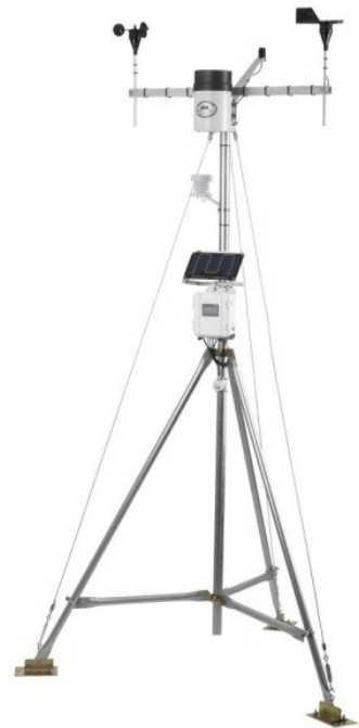
Imagen 27. Estación meteorológica HOBO U30.
