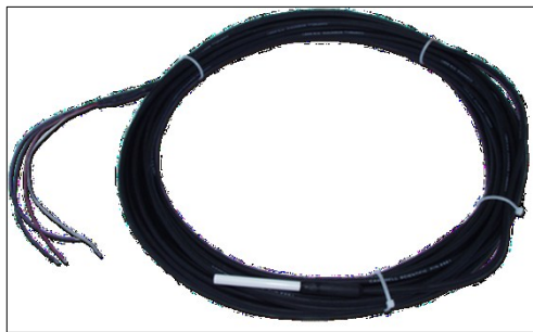
Imagen 22. Probeta sensible a la temperatura, Campbell Scientific modelo 107.
