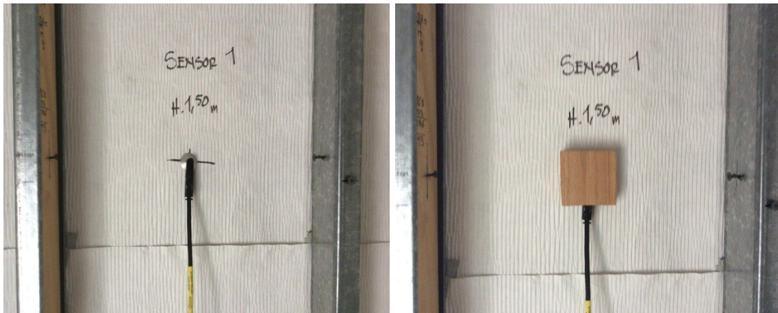
Imagen 33. Proceso de colocación del sensor Campbell Scientific 110 PV, al interior del muro.
