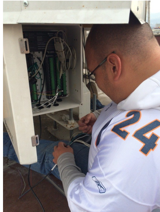
Imagen 38. Conexión de los sensores al Adquisidor de Datos.
