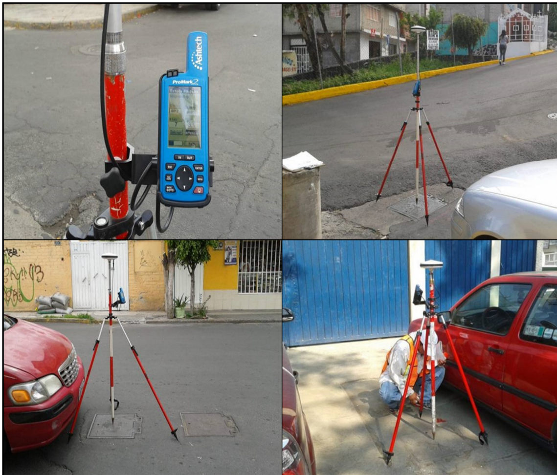
Figura III.19. Georeferenciación de cajas con GPS en la delegación GAM. Fuente: PSC, 2013.
