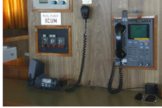
Foto 9 y 10. A la izquierda, el Cuarto de Cómputo con los monitores del CTD, de la ecosonda y del sistema GPS. También se aprecia la carta naval desplegada sobre la mesa. A la derecha, el sistema de comunicación dentro de la Cabina del Capitán, desde donde puede dirigirse a cualquier laboratorio, camarote o al Cuarto de máquinas.
