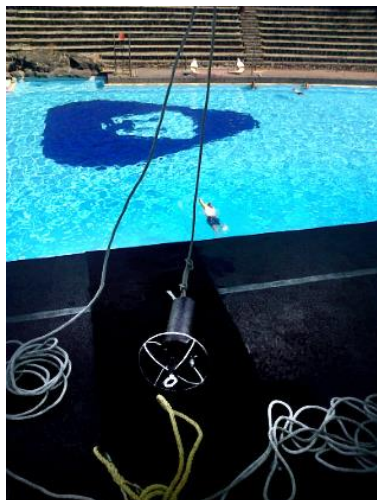
Foto 4 y 5. A la izquierda, desde la plataforma de clavados (a 10 metros de altura) en la Alberca Olímpica de la UNAM, se ensaya el descenso de un instrumento con sensores parecidos a los del CTD. A la derecha, una botella Van Dorn que colecta muestras de agua a partir de un mecanismo manual de cierre. La práctica se realizó el 22 de febrero de 2016, dos meses antes de la salida del buque (Véase Anexo 9)
