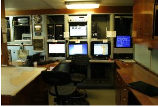
Foto 9 y 10. A la izquierda, el Cuarto de Cómputo con los monitores del CTD, de la ecosonda y del sistema GPS. También se aprecia la carta naval desplegada sobre la mesa. A la derecha, el sistema de comunicación dentro de la Cabina del Capitán, desde donde puede dirigirse a cualquier laboratorio, camarote o al Cuarto de máquinas.
