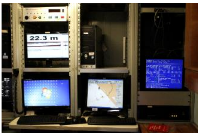
Foto 3. En orden de arriba abajo, y de izquierda a derecha: el monitor que reporta la batimetría, el monitor que arroja las gráficas de la masa de agua, luego el monitor del GPS en representación gráfica, y finalmente el monitor que arroja datos de geolocalización en valores numéricos.
