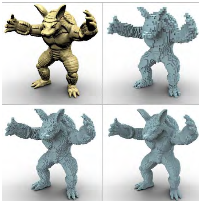
Figura 3-1. Voxelizaciones realizadas con scanline a distintas resoluciones.
